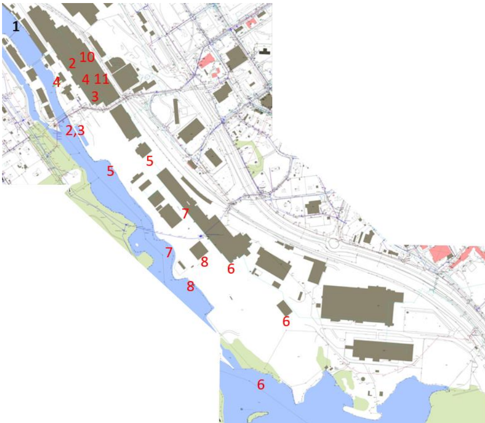
Figur 13 . Intag och utsläpp av vatten. Siffrorna i figuren är placerade dels där respektive process sker och dels var respektive utsläpp sker. Nummer ett motsvarar plats för vattenintaget och resterande siffror visar var utsläpp sker till Kolbäckån respektive var i processen vattnet kommer ifrån. Se Tabell 3 för närmare förklaring av siffrorna.
